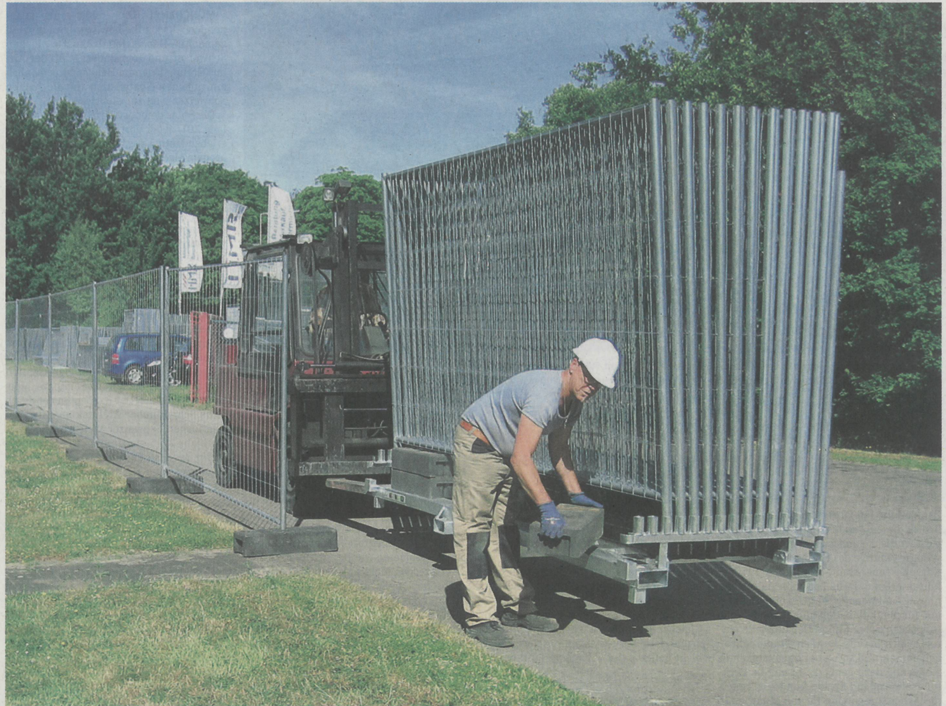
Die Kombipaletten von H.M.R. sind auf das jeweilige Absperrmaterial zugeschnitten, um Transport- und Lagerplatz optimal auszunutzen – 15 zusammengeklappte Kombipaletten benötigen eine Stellhöhe von 2,40 m. Foto: H.M.R.
